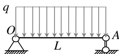
На участке  $OA$  балка нагружена вертикальной погонной силой с интенсивностью  $q$ , равной 8 Н/м. Величина реакции опоры, приложенной в точке  $A$  балки, равна...
