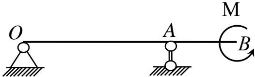
Балка нагружена парой сил в вертикальной плоскости балки с моментом, величина М которого равна 8 Н·м и приложенным на конце  $B$  балки. Определить величины реакций опоры, приложенной в точке  $A$  балки.
