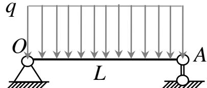
На участке  $OA$  балка нагружена вертикальной распределенной силой с интенсивностью  $q$ , равной 8 Н/м. Определить величины реакций опоры, приложенной в точке  $A$  балки.
